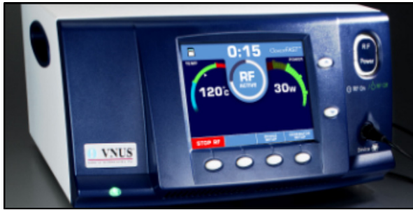
Figura 4 – Generador RFG2 Plus™. El display de la unidad de control muestra en tiempo real la potencia, temperatura y ciclos de tratamiento.
